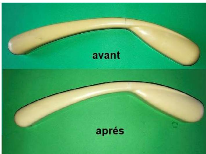
La présence de bulles autour de l'objet est la manifestation de la réaction chimique de l'eau oxygénée en présence d'UV. Vous pouvez comparer la couleur avant l'immersion et après l'immersion (pendant 5h) le changement de couleur
